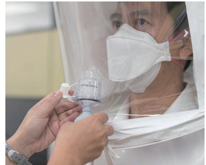
图9： 定性适合性测试
