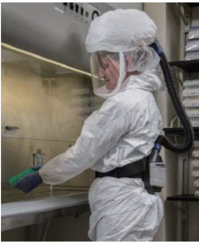
图 7： 动力送风过滤式呼吸器
