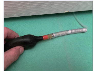
图4： 在门缝处使用发烟管
