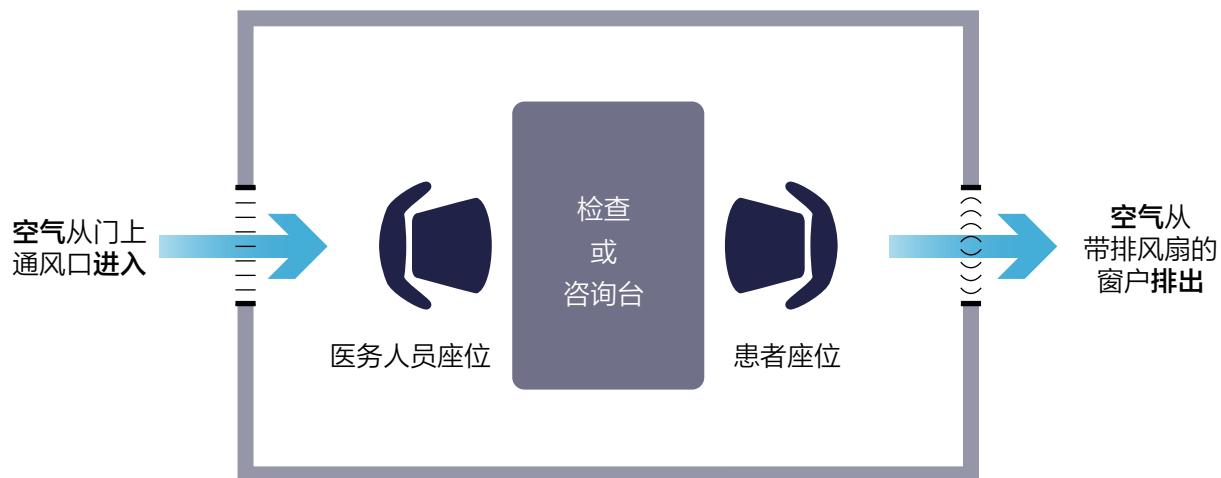
图2A: 单向气流房间布局: 使用仅排风窗式排风扇的单向气流房间布局示例（结核检查室或诊室）
